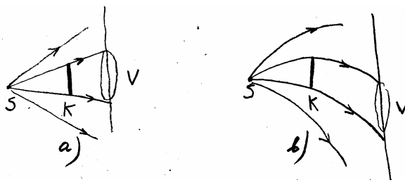
Joonis 6.2. Varju tekkimine valguse sirgjoonelise leviku korral (a) ja kõverjoonelise leviku korral (b). S – valgusallikas, K – keha, V- vari ekraanil.
