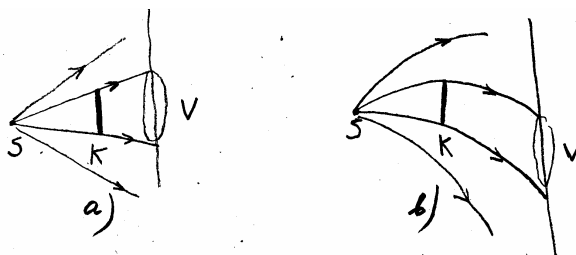
Joonis 12.2. Varju tekkimine valguse sirgjoonelise leviku korral (a) ja kõverjoonelise leviku korral (b). S – valgusallikas, K – keha, V- vari ekraanil.
